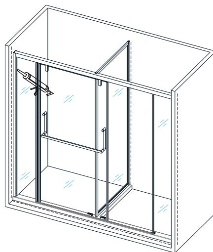
安装完成后，用中性玻璃胶把靠墙型材与墙壁间、石基与墙壁间、滑道与大理石间的缝隙密封(如图8虚线所示)，待24小时玻璃胶完全干透后，方可放心使用。
